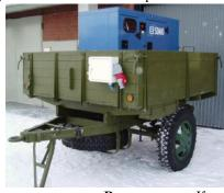
6. Электростанция дизельная мобильная SDMO T20HK на одноосном прицепе. Выполнены: Комплектация оборудования, изготовление специальной рамы с салазками и дополнительными дугами защиты оборудования, монтаж оборудования на прицеп, специальный рамный блок управления и электропитания для возможности подключения потребителей (оборудования, инструмента), ПНР, тестирование. (Передвижной пункт электроснабжения предприятия Челябинской области).
