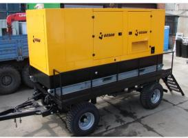
3. Электростанция на двухосном прицепе на базе ДГУ EKO D120MS в кожухе мощностью 120 кВа. Выполнены: Комплектация и монтаж оборудования на прицеп, ПНР, тестирование под нагрузкой. (Для использования в качестве резервного передвижного пункта электропитания для баз отдыха при отключениях электроэнергии в Свердл. обл.).
