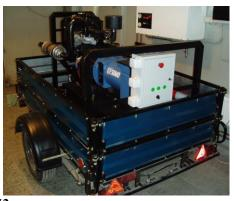
7. Электростанция дизельная резервная ВЕПРЬ АДА 20Т400РЯ2 в исполнении на стандартном одноосном прицепе. Выполнены: Комплектация оборудования, изготовление специальной рамы для оборудования, монтаж оборудования на прицеп, ПНР, тестирование. (Пункт резервного электропитания районной средней школы Свердловской области).
