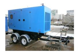
4. **Дизельная электростанция 40 кВт на одноосном прицепе. Выполнены:** Комплектация оборудования, изготовление утепленного кожуха с дымоудалением, установление подогревателя охлаждающей жидкости, монтаж оборудования на прицеп, ПНР, тестирование. (Передвижной пункт электропитания на предприятии Пермского Края).
